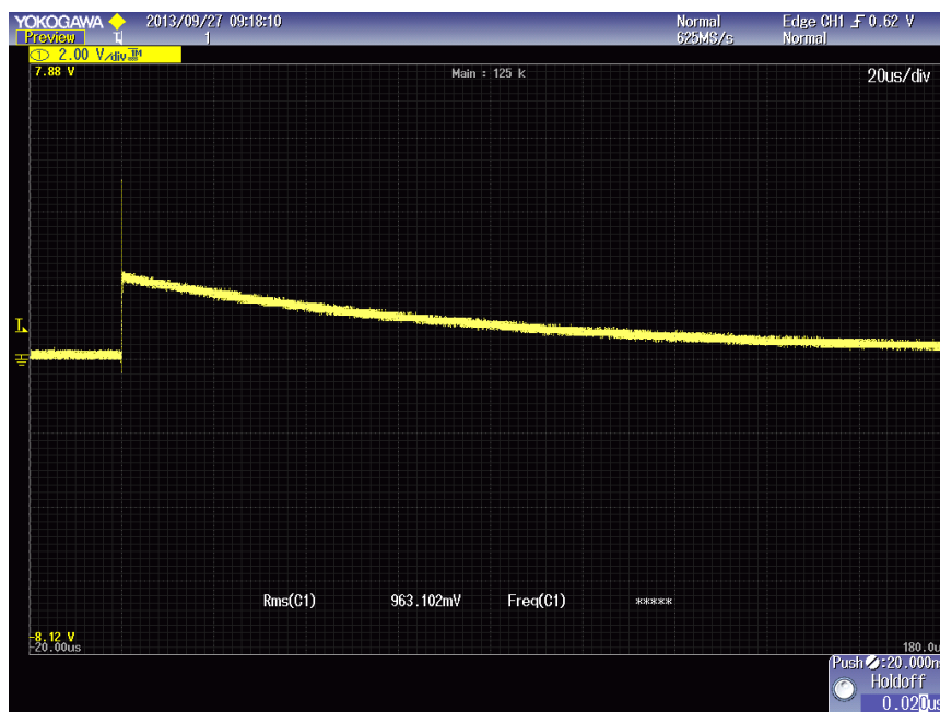
Figur 3: Strømforløp med bare motstand (person uten beskyttelse).
